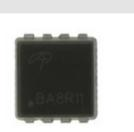
**AON6442 Description:** MOSFET N-CH 40V 22A DFN5X6
